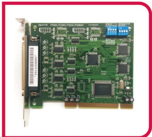
只需要5V电源就可以工作的PCI串口卡
