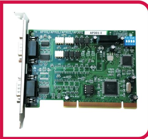
PCI插槽专用的2个串口卡
