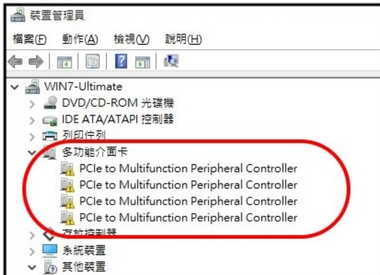
6. 當電腦重新開機後，如下圖，時可以在控制台=>系統及安全性=>系統=>裝置管理員下看到 4 個 PCIe to Multifunction Peripheral Controller，和 4 個 PCIe to High Speed Serial Port(COM 2~5)都完全安裝完畢，就代表自動安裝驅動完成。
